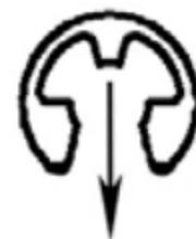
**Circlips de verrouillage
